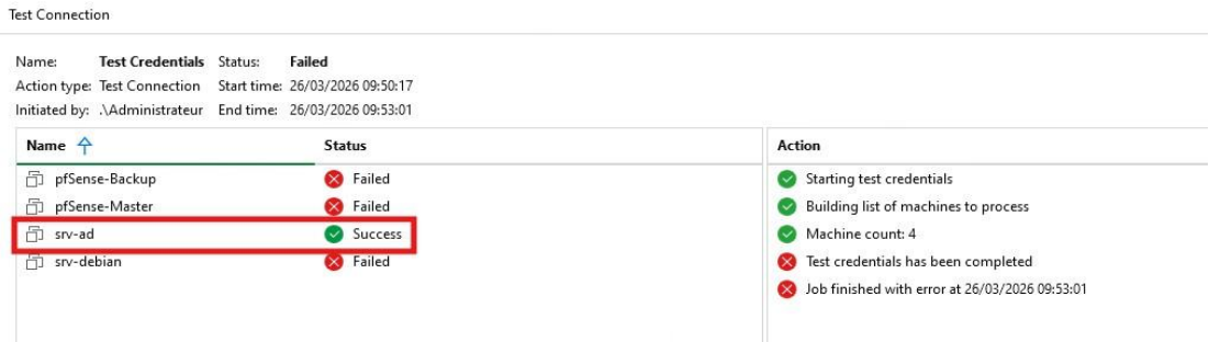
Figure 51 : Résultat du test Guest Processing - succès pour le serveur AD, échec attendu pour pfSense et le serveur Debian (non-Windows)
